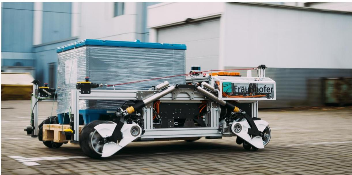
**Federung / suspension** Luftfederung mit mechanischen Stoßdämpfern / *air spring with mechanical damper*
