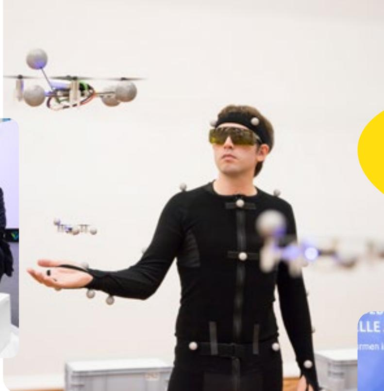
**Schwarmintelligenz hebt ab:** Mittels hochverteilter Künstlicher Intelligenz und 5G kommunizieren auf dem Digital-Gipfel im ersten biointelligenten Drohnenschwarm 20 Drohnen ohne zentrale Steuerung.
