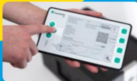
9 mm hoch, einsteckbar, 5G-kompatible Kommunikation, hochauflösendes Display (1440 x 1072 Pixel), Sensoren für Temperatur, Beschleunigung, Lage. Akkulaufzeit: bis zu 2 Jahre
