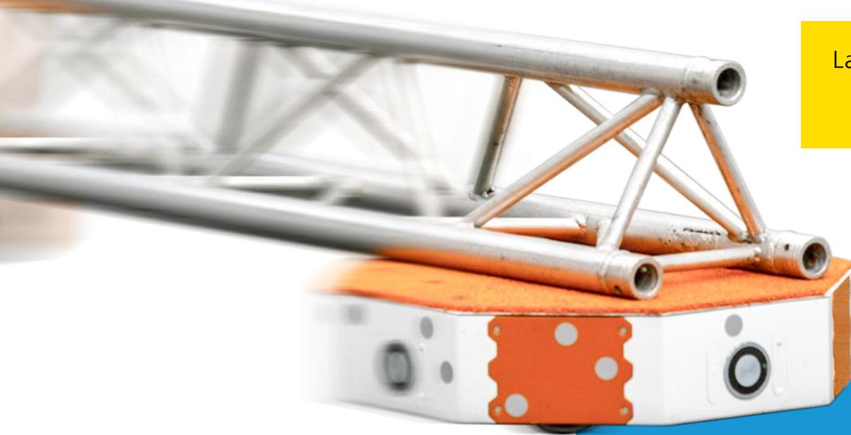
sich des trägheitsbasierten Übergabepinzips: Die Lastabgabe erfolgt ausschließlich mittels Trägheit beim Abbremsen des Fahrzeugs – also ohne zusätzliche Aktorik.
