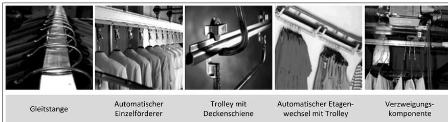
Abb. 6.2. Beispiele für Hängefördertechnik [VDI07c]
