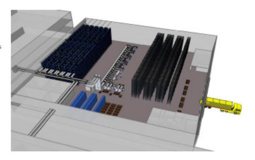
Herausforderungen bei der Umsetzung, da eine Vielzahl von Umzügen und Interimslösungen notwendig wurde. Für den Vorzugsstandort wurde ein neues Lagerkonzept entwickelt, dessen Herzstück ein vollautomatisches Kleinteilelager ist. Modern und ergonomisch gestaltete Kommissionier- und Verpackungsarbeitsplätze sowie Fördertechnikanbindungen an die Produktionsbereiche rundeten das Gesamtkonzept ab.
