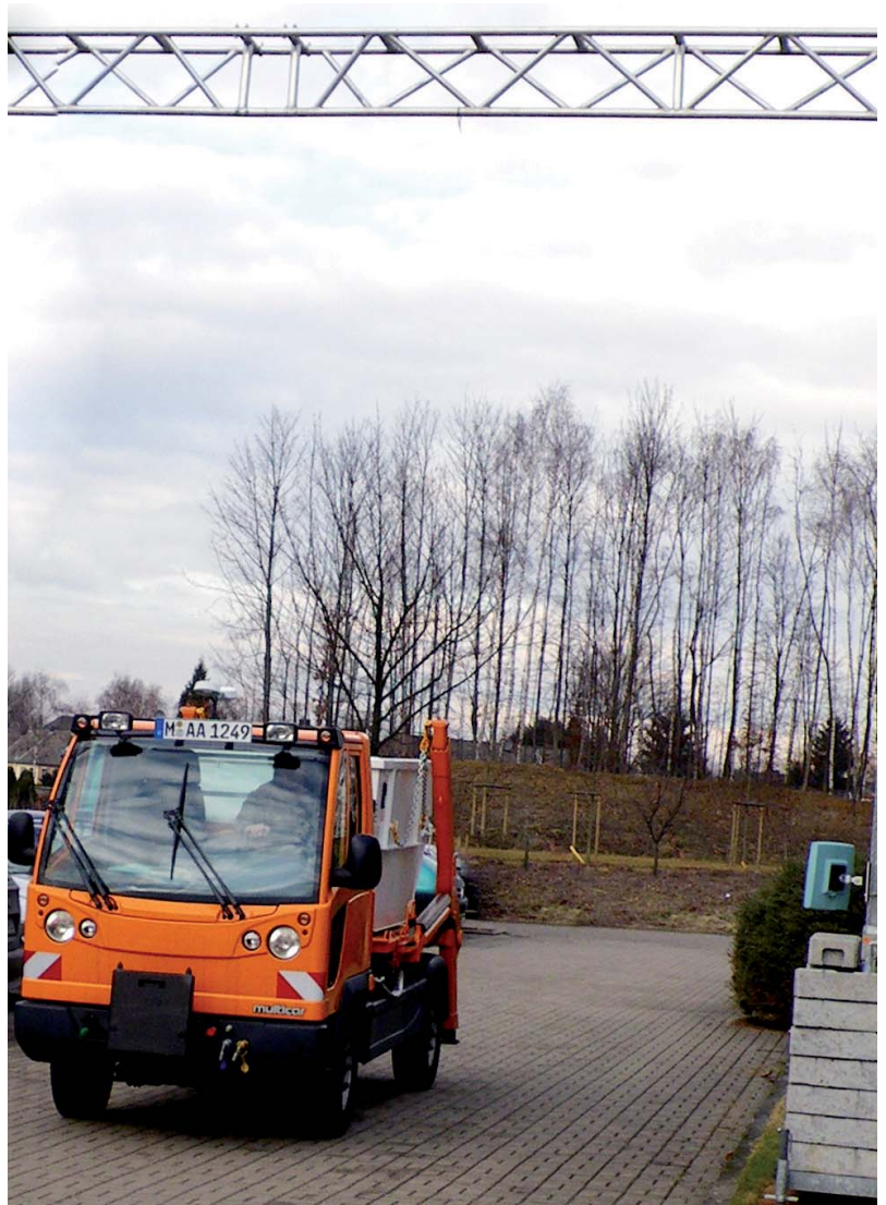
Versuchsanordnung 2: Das Kommunalfahrzeug mit RFID-Tags am Container beim Passieren eines stationären RFID-Lesegates.
