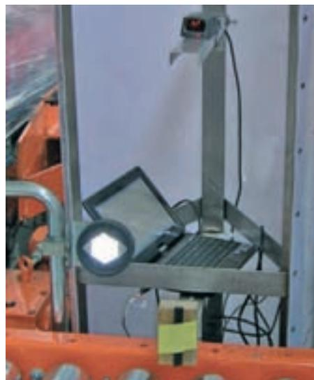
Exemplarischer Aufbau des Kombinator: Oben befindet sich der Barcode-Reader, unten die RFID-Leseantenne.
