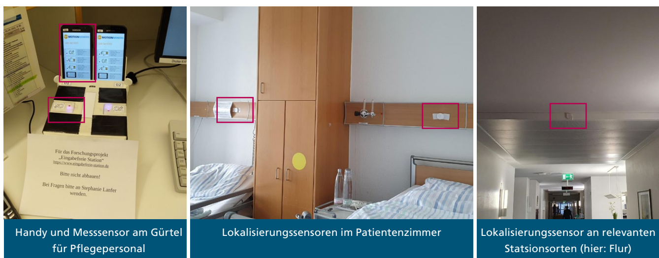
Abbildung 7: Verwendete Messtechnik, Mobiltelefon und Sensoren (links), angebrachte BLE-Funksender (Mitte, rechts) (Quelle: MotionMiners GmbH)
