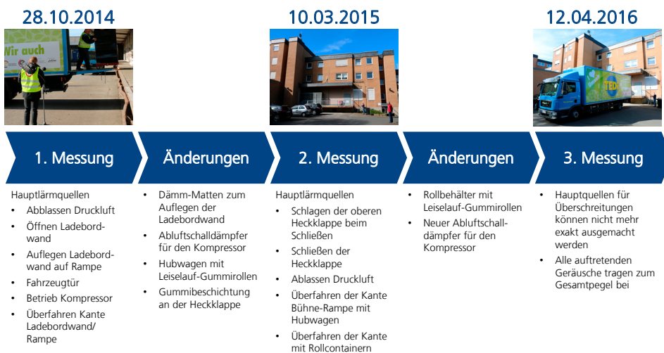
Abbildung 10: Änderungen am Fahrzeug zur Reduzierung der Hauptlärmquellen
