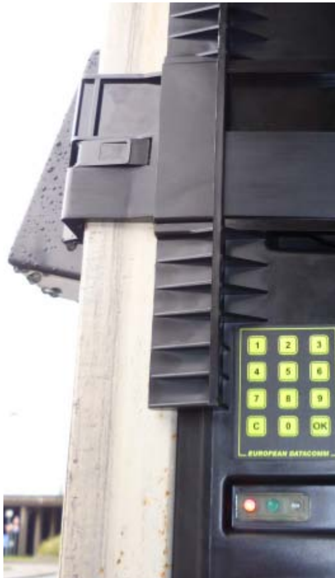
Ein smarter Seecontainer: Ausgestattet mit einer Containerüberwachungseinheit CSD kann der Container jederzeit und überall durch Satellitenkommunikation überwacht werden. Dies ist eine operative Basis für das Seecontainer-Management.
