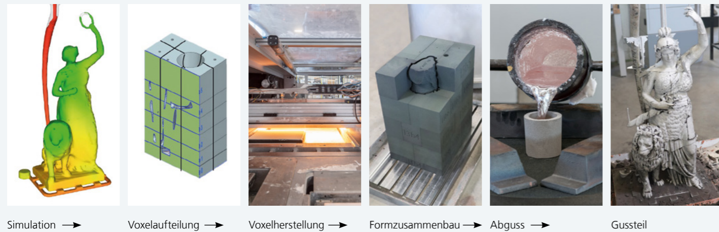
Simulation → Voxelauflösung → Voxelherstellung → Formzusammenbau → Abguss → Gussteil
