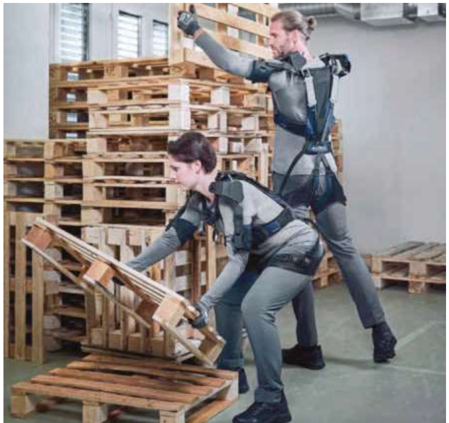
Das Omnisuit-Design dieses Mehrzweck-Exosketts unterstützt die Schultern bei Überkopfarbeiten und den Rücken beim Heben und Vorwärtsbeugen.
